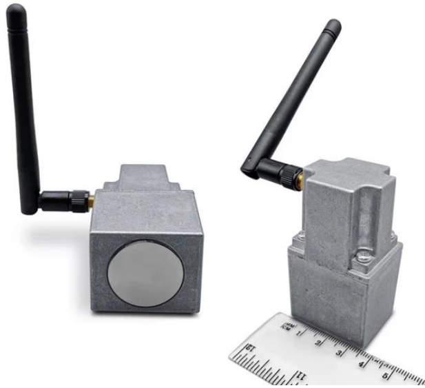
6 pav. Nordic Semiconductor Industrial Bluetooth LE vibracijos ir temperatūros jutiklis (šaltinis: https://www.nordicsemi.com )
