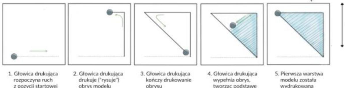
A execução da primeira camada abaixa completamente o modelo ao longo do eixo Z ou eleva a cabeça ao longo do eixo Z. Graças a isso, aplicando camada por camada, é criado um modelo tridimensional. Após o término da impressão, removemos nosso sólido do leito de aquecimento.
