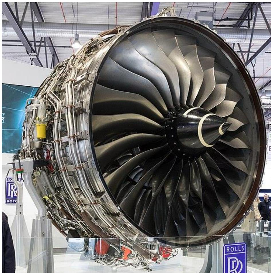
Figura 7 Ventilador do motor Rolls-Royce Trent XWB. Imagem: Matti Blume / CC BY-SA / WikiMedia
